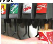
7. Retirer et nettoyer les buses (Nozzle) et les diffuseurs des valves et nettoyer avec une petite brosse et une solution de désinfection de qualitéalimentaire (Kay5), remplacer une fois terminé.
